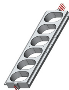
Beispiel 6 / example 6 z.B. für Spinnfadentrocknung e.g. for strand drying
