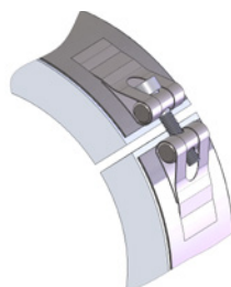
Beispiel 5 / example 5 direkt verschraubt mit Spannband direct screwed with clamp band
